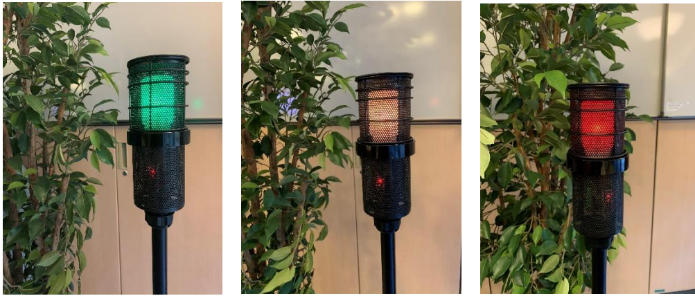
写真3 フルカラー型ポールでの点灯部分の色変化（左から緑色、黄色、赤色）
